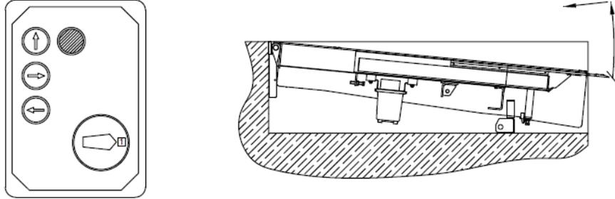
Дополнительно на лицевой стороне блока управления CUL11-3 размещена наклейка для операторов, наглядно информирующая о недопущении задвигания аппарели, когда платформа расположена ниже уровня пола помещения, а также о недопущении эксплуатации оборудования при выключенном электропитании.
