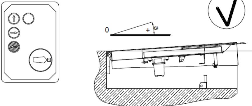
**2** Не допускается выполнять задвигание аппарели при нахождении платформы ниже горизонтального уровня рампы!
