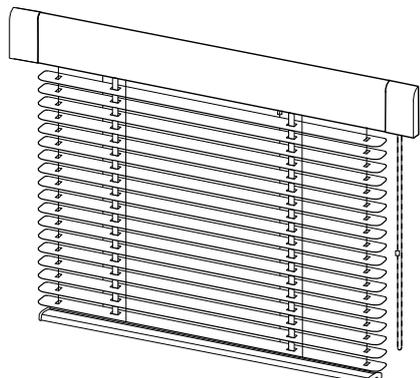
Система горизонтальных кассетных алюминиевых жалюзи, разработана специально для установки на рамы пластиковых окон.
