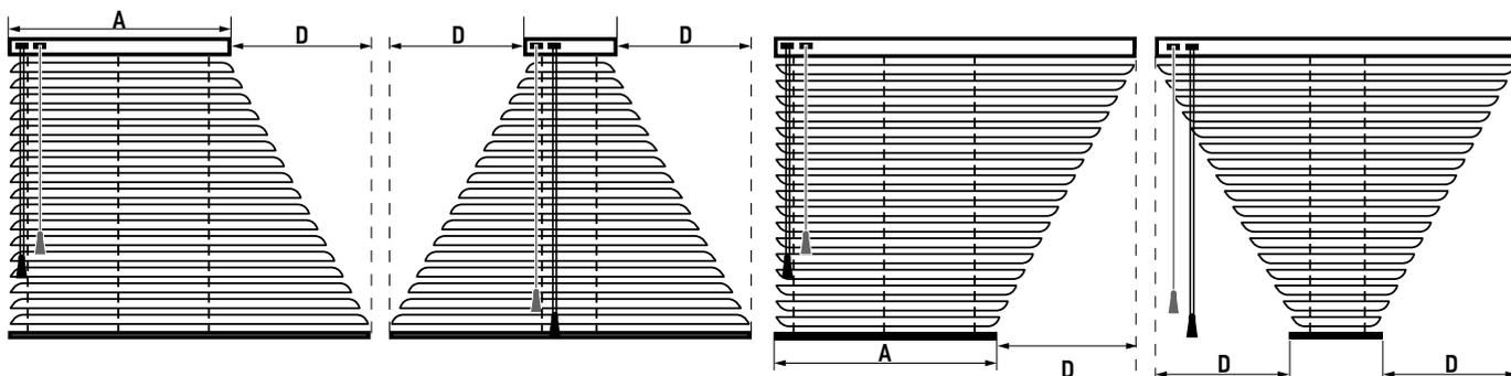
Модели предназначены для закрытия проемов окон трапециевидной формы с небольшим скошенным краем. Верхний карниз расположен всегда горизонтально. При установке внутрь проема изделия работают только на поворот ламелей. Боковая фиксация не предусмотрена. Шнуры управления могут располагаться с любой стороны. Для прямоугольных трапеций рекомендуется их расположение с прямой стороны.
